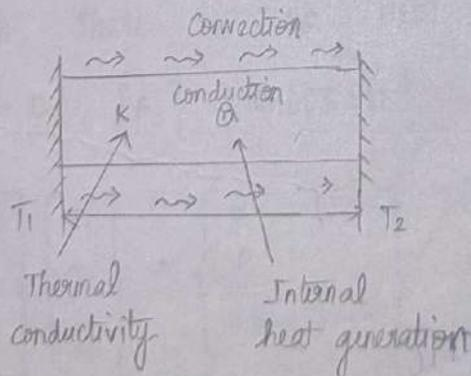
$$\left[ \frac{AK}{l} \begin{bmatrix} 1 & -1 \\ -1 & 1 \end{bmatrix} + \frac{hpl}{6} \begin{bmatrix} 2 & 1 \\ 1 & 2 \end{bmatrix} \right] \begin{Bmatrix} T_1 \\ T_2 \end{Bmatrix} = \frac{qAl + PhT_{\infty}l}{2} \begin{Bmatrix} 1 \\ 1 \end{Bmatrix}$$
