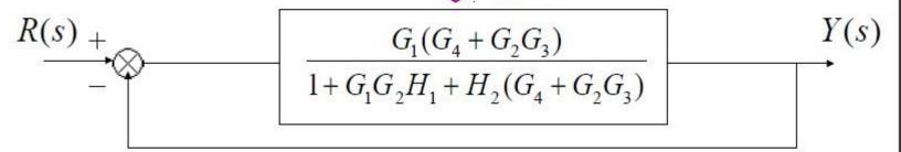
$$T(s) = \frac{Y(s)}{R(s)} = \frac{G_1(G_4 + G_2G_3)}{1 + G_1G_2H_1 + H_2(G_4 + G_2G_3) + G_1(G_4 + G_2G_3)}$$
