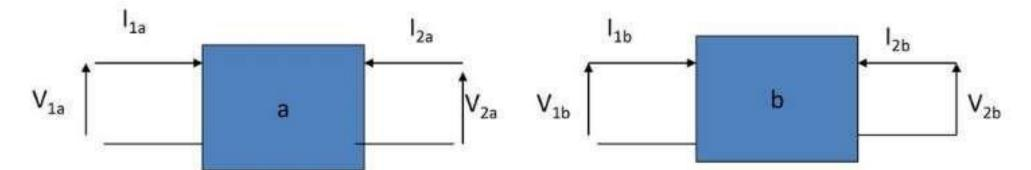
$$\begin{bmatrix} V_{1a} \\ I_{1a} \end{bmatrix} = \begin{bmatrix} A_a & B_a \\ C_a & D_a \end{bmatrix} \begin{bmatrix} V_{2a} \\ -I_{2a} \end{bmatrix} \qquad \begin{bmatrix} V_{1b} \\ I_{1b} \end{bmatrix} = \begin{bmatrix} A_b & B_b \\ C_b & D_b \end{bmatrix} \begin{bmatrix} V_{2b} \\ -I_{2b} \end{bmatrix}$$
