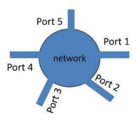
$$\begin{bmatrix} b_1 \\ b_2 \\ b_3 \\ b_4 \\ b_5 \end{bmatrix} \begin{bmatrix} S_{11} & S_{12} & S_{13} & S_{14} & S_{15} \\ S_{21} & S_{22} & S_{23} & S_{24} & S_{25} \\ S_{31} & S_{32} & S_{33} & S_{34} & S_{35} \\ S_{41} & S_{42} & S_{43} & S_{44} & S_{45} \\ S_{51} & S_{52} & S_{53} & S_{54} & S_{55} \end{bmatrix} \begin{bmatrix} a_1 \\ a_2 \\ a_3 \\ a_4 \\ a_5 \end{bmatrix}$$
