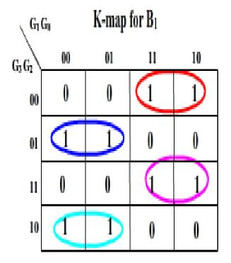
$B_1 = G'_3 G'_2 G_1 + G'_3 G_2 G'_1 + G_3 G_2 G_1 + G_3 G'_2 G'_1$  $= G'_3 (G_2 \bigoplus G_1) + G_3 (G_2 \bigoplus G_1)'$  $= G_1 \oplus G_2 \oplus G_3$
