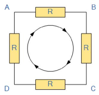
$$V_{AB} + V_{BC} + V_{CD} + V_{DA} = 0$$
