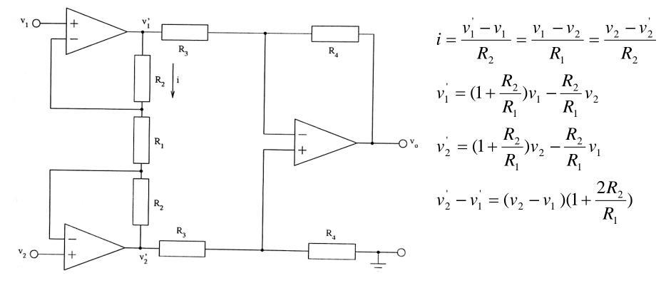
When  $v_1 = v_2 = v_{cm}$ ,  $A_{cm} = 1$
