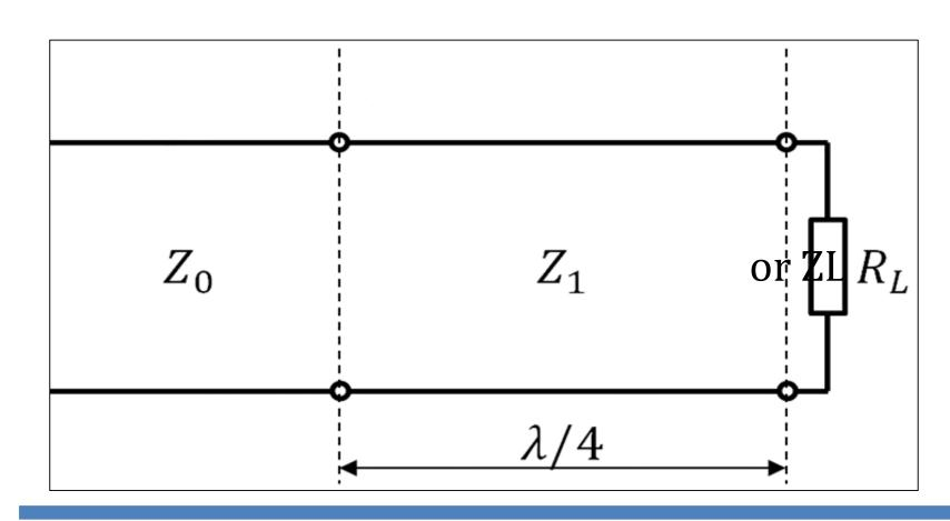
IMPEDANCE MATCHING & QUARTER WAVE LINE/19EC502-TRANSMISSION LINES AND ANTENNAS/MUBARAALI L
